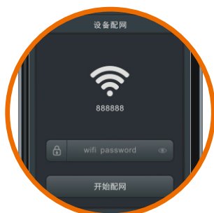
7、输入WiFi密码，开启产品电源10秒内完成以下步骤，短按遥控“灯”1路灯键2下，第3下长按3秒以上，听到“滴”一声，再按APP“开始配网”键。
